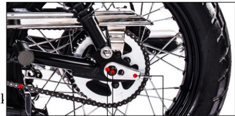
链条 紧锁螺母 后轮轴 链条调节器
