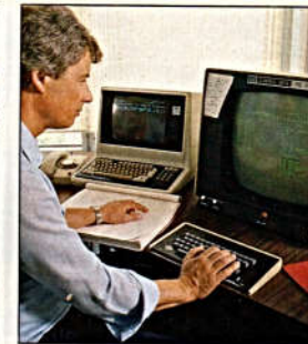
Ein Extra-Rechner bereitet die Programme so auf, daß sie mit optimaler Geschwindigkeit vom Cyber verarbeitet werden können. Auf dem linken Monitor wird angezeigt, welches Programm gerade gerechnet wird.
