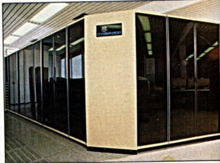
Professor Klaus Hasselmann (oberes Bild, Mitte) und seine Mitarbeiter haben mit dem Cyber 205 (rechts) jetzt einen Computer zur Verfügung, der aufgrund seiner Größe und Schnelligkeit Simulationen erlaubt, die vorher zu aufwendig waren. Mit Hilfe von Vector-Processing (mehr darüber im Bericht) schafft dieser Rechner 400 Millionen Rechenoperationen pro Sekunde. Rechts unten: ein Blick auf das Rechenwerk im geöffneten Computer.
