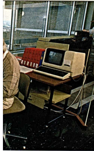
Ein Extra-Rechner bereitet die Programme so auf, daß sie mit optimaler Geschwindigkeit vom Cyber verarbeitet werden können. Auf dem linken Monitor wird angezeigt, welches Programm gerade gerechnet wird.
