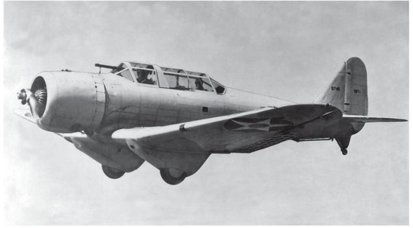
▲ Le Northrop XBT-1 (BuAer 9745). En dépit de son train partiellement escamotable, l'avion présente une allure étonnamment moderne par rapport à celle de la plupart de ses concurrents. On note qu'il est équipé des volets/freins de piqué ajourés. (US NARA)
