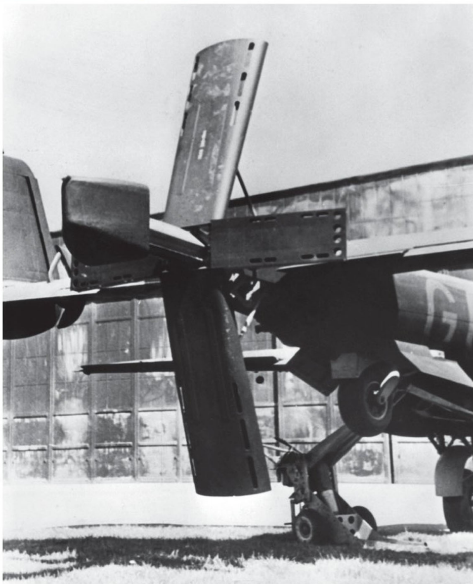
▲ Une vue des freins de piqué d'un Dornier Do 217 E s'ouvrant en corolle. Le mécanisme, fragile, supporte mal les contraintes des ressources violentes en cas de piqué prononcé et bloque fréquemment les freins en position ouverte, ce qui peut placer l'avion dans une situation délicate lors du trajet retour. (ww2images.com)
