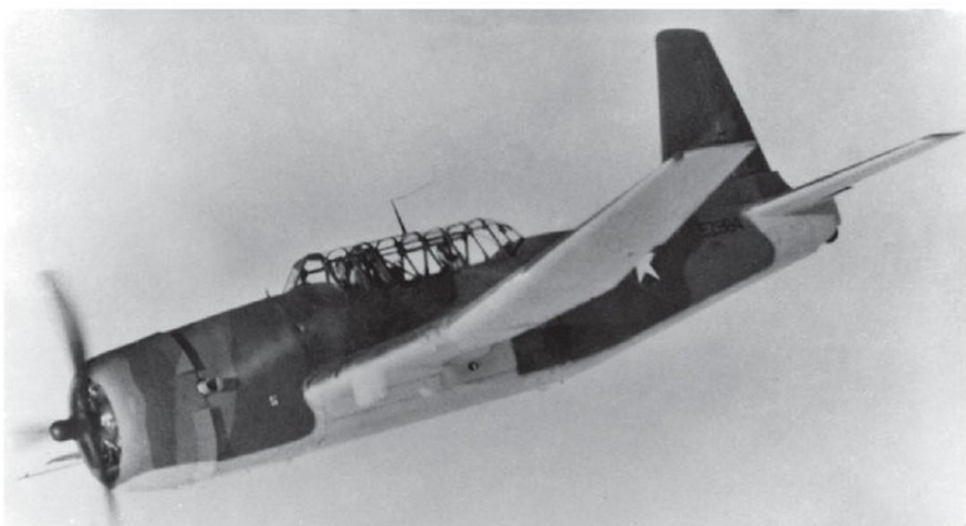
▲ Un des A-31 détournés par l'USAAF des commandes passées pour la RAF. L'avion porte l'étoile américaine postérieure à mai 1942 et le serial britannique EZ994 ; il recevra le call sign number 41-31042. (RAF Museum)
