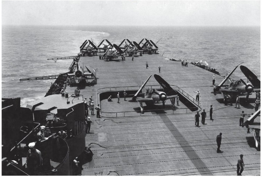
▲ Cette photo a été prise à bord de l'USS Yorktown II (CV-10) lors des essais de qualification avec les VB-4 et VB-6, en avril 1943. On peut noter la taille compacte du SB2C-1 sur l'ascenseur arrière, qui devait permettre de monter sur le pont deux appareils en même temps, exemple « d'une vraie fausse bonne idée », qui contraindra le bureau d'études à des contorsions préjudiciables aux caractéristiques de vol de « the beast ». (US NARA)
