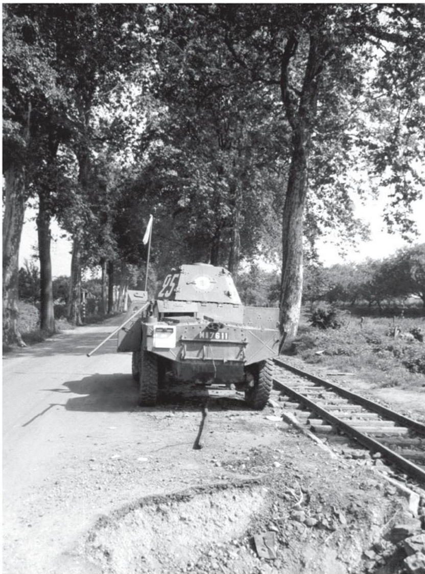
▲ Vue arrière de l'Ardente, M 7611 du sous-lieutenant de Vasselot. À l'avant-plan, le cratère dû à l'explosion de la mine qui a endommagé l'AM est bien visible. Coll. de l'auteur
