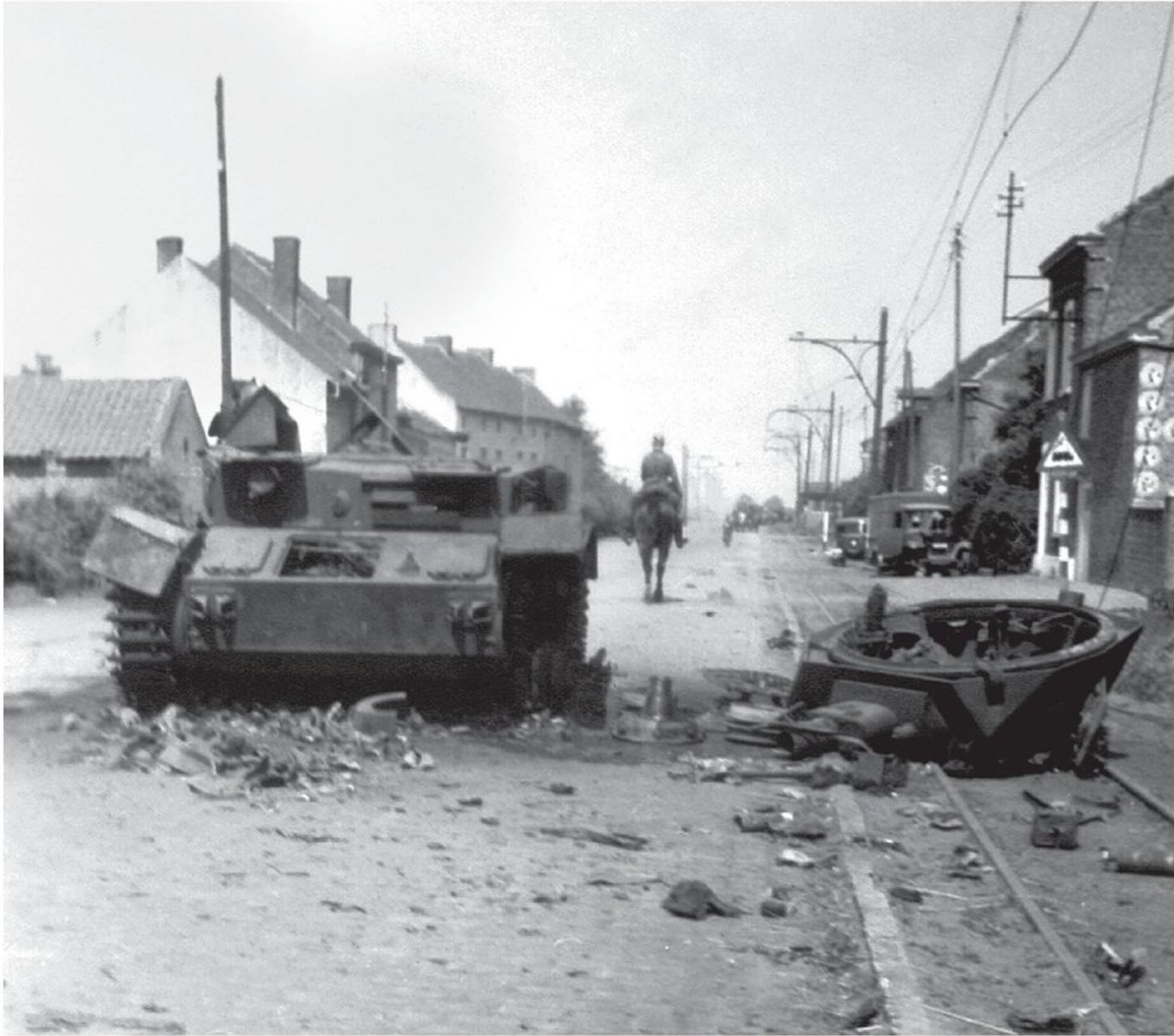
▲ Vue rapprochée du Panzer IV détruit par le sous-lieutenant de Vasselot. L'incendie ayant fait sauter les munitions, la lourde tourelle du char a été soufflée par l'explosion. (Coll. de l'auteur)
