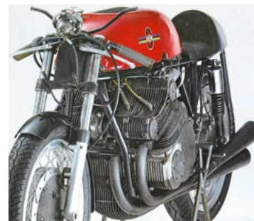
Letzte Ausbaustufe: Der für 1958 gemeinsam mit Ferrari entwickelte, breitere, verrippte Zylinderkopf
