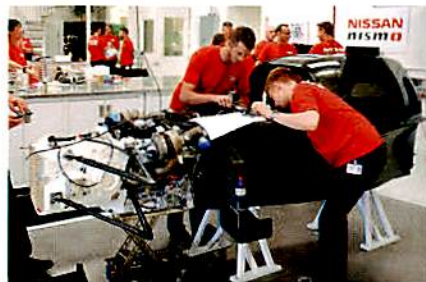
LMP1 umgedreht: Ganz vorne sitzt das Getriebe, dann kommt der V6-Motor
