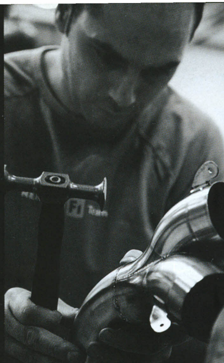
Obrada rubova upravo izrezane cijevi od inkonela i (gore) fina dorada
