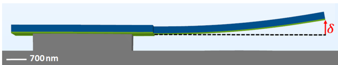
Figure 25: Courbure du nanobeam due à l'application d'un champ électrique selon z , pour V = 200 \text{ V} , \delta = 5 \text{ nm} .
