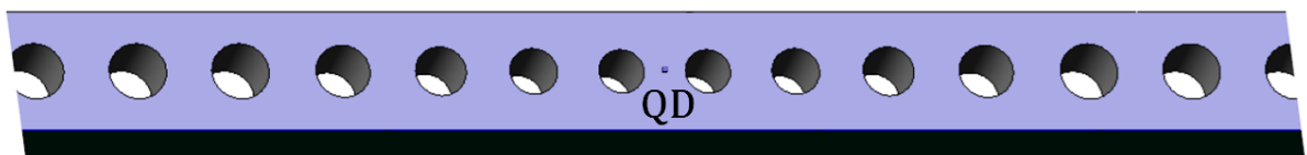
Figure 30: Insertion d'une boîte quantique au centre de la cavité d'un nanobeam [38].
