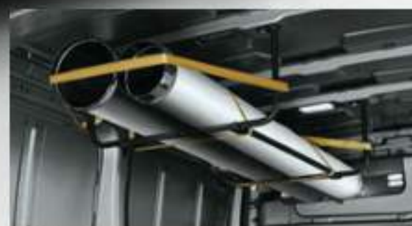
Csőszállításra ott a mennyezeti konzol, de a válaszfali csapóajtó is hasznos
