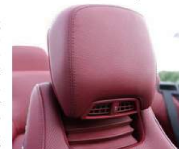
Több fokozatban állítható a légsál befúvási erőssége
