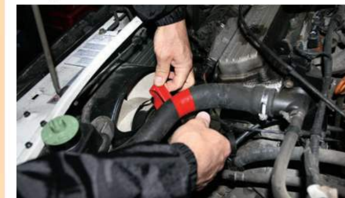
A sérült csőszakasz betekerésekor figyelni kell rá, hogy a szalag mindig átfedésben legyen. Sok esetben „életmentő” lehet
