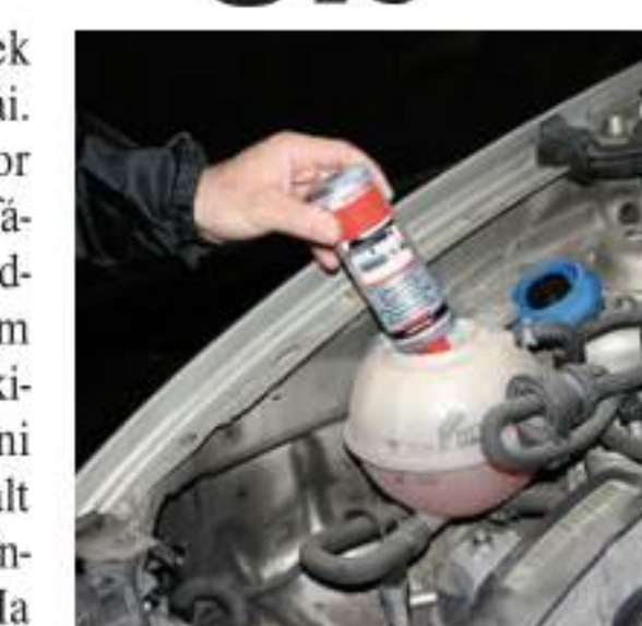
A tömítőanyag a hűtőrendszerbe jutva gátolja a szivárgást
