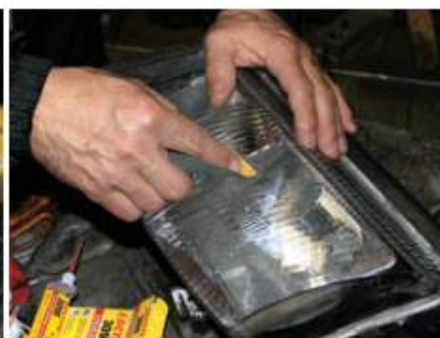
Száradás után finom csiszolóval hoztuk síkba a javítást
