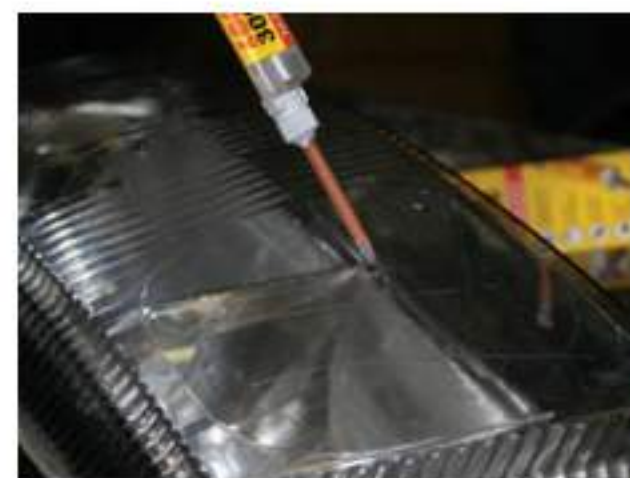
A sérülés kifúrtuk, majd feltöltöttük a kétkomponensű ragasztóval
