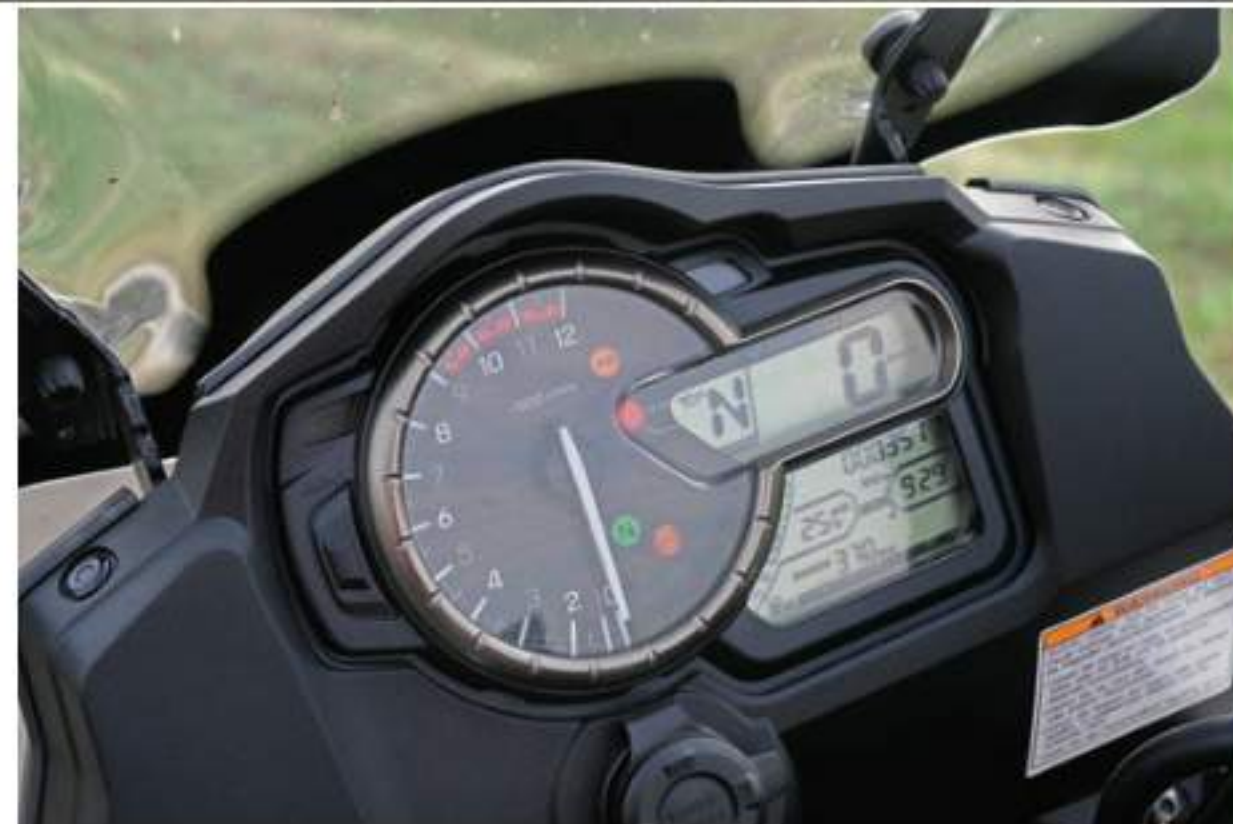
Több újdonság: fokozatjelző, fedélzeti számítógép és állítható fényerő
