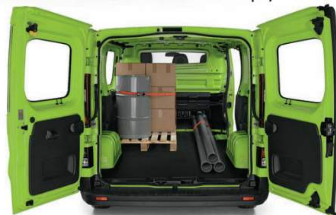
Csőszállításra ott a mennyezeti konzol, de a válaszfali csapóajtó is hasznos
