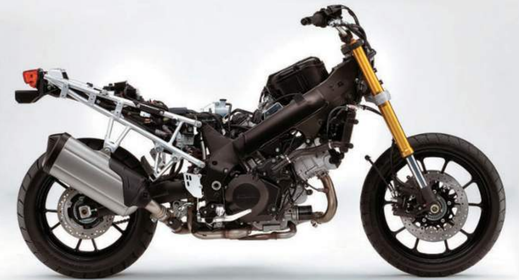
Meredekbő villaszög (25,3 fok) és két centivel nagyobb tengelytáv jellemzi az új generációt
