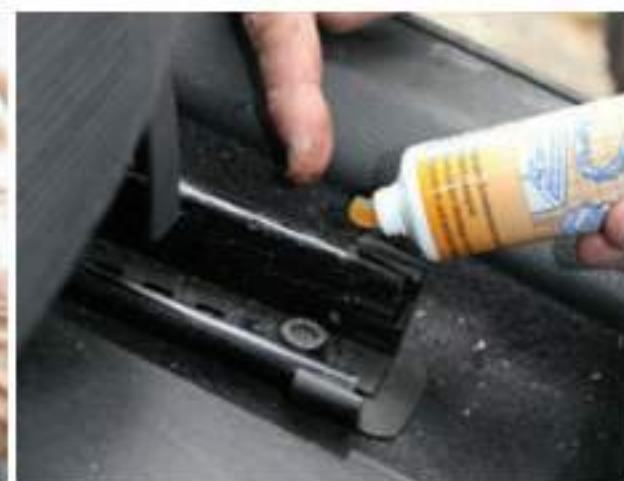
Az utastérben is jól tapadó, hőre nem folyósodó zsírt használjunk
