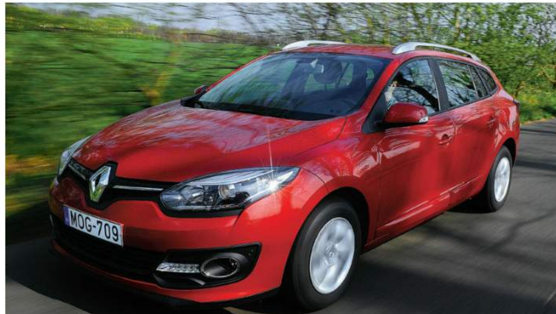
A feláras LED-es nappali menetfények a frissítés során a fényszóróházból a lökhárítóba költöztek
