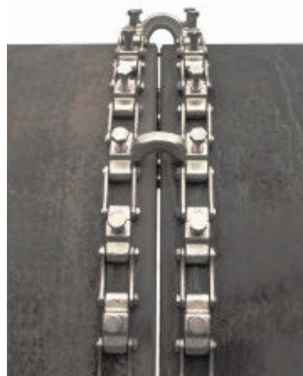
Pozycjoner S300 jednorzędowy, łańcuch typu extra- ciężkiego
