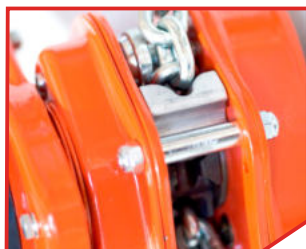
ściągnacz łańcucha umożliwiający bezpieczne prowadzenie łańcucha ładunkowego na lub z krążka ładunkowego bez zaczeplania lub zakleszczania w dowolnej pozycji
