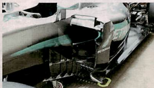
Mercedes: Die modifizierten Bargeboards am W07
