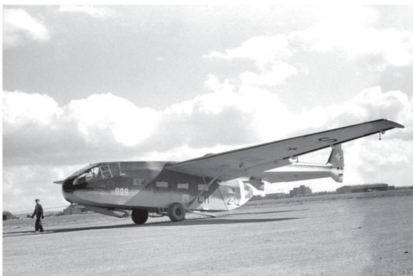
▲ Le planeur d'assaut Go 242, conçu pour le transport de 23 soldats complètement équipés, a été fabriqué également en version cargo. C'est le cas de cet exemplaire, qui semble être du modèle B-1 équipé d'un train d'atterrissage largable. Il porte le code tactique de la LLG 2. (ECPA-D)
