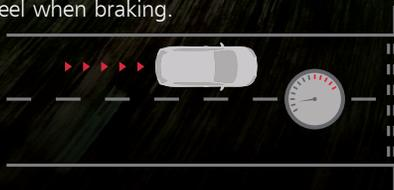
**Шарвалтын эсрэг систем.** Уг систем нь автомашин эргэлт хийх үед жолоодлогоо алдалгүй, нэгэн жигд явахад чухал нөлөөтэй. Машины компьютер нь эргэлтийн үед замын нөхцөл байдлыг тооцоолон, шаардлагатай тохиолдолд дугуй тус бүрийг өөр хүчээр тоормослуулж илүү найдвартай жолоодох боломжийг олгодог.
