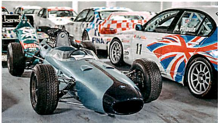
BT7-Rekordwagen: Das Chassis stammt von Brabham, die Antriebseinheit von BMW. Der Vierzylinder leistete 290 PS bei 8500/min
