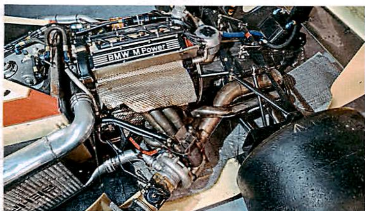
Bayerisches Kraftpaket: Der Vierzylinder-Turbo mit 1,5 Litern Hubraum entfesselt in seinen besten Tagen 1400 PS. Hier sitzt der Motor im Arrows A8
