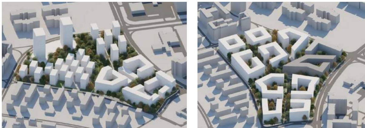
Слика 10 и 11: Варијанте физичке структуре - Варијанта А: i = 2,9 ; z = 25\% и Варијанта Б: i = 2,8 ; z = 35\%
