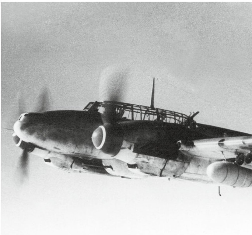
▲ Le Bf 110 G-2/R3 (ici, un appareil de la 4./ZG 76) portait un armement « survitaminé » se composant de deux MK 108 dans le nez, deux MG 151/20 en gondole ventrale et quatre lance-grenades sous les ailes, idéal pour « casser » du bombardier, mais aussi pour servir de cible d'entraînement à la chasse US ! (ww2images.com)
