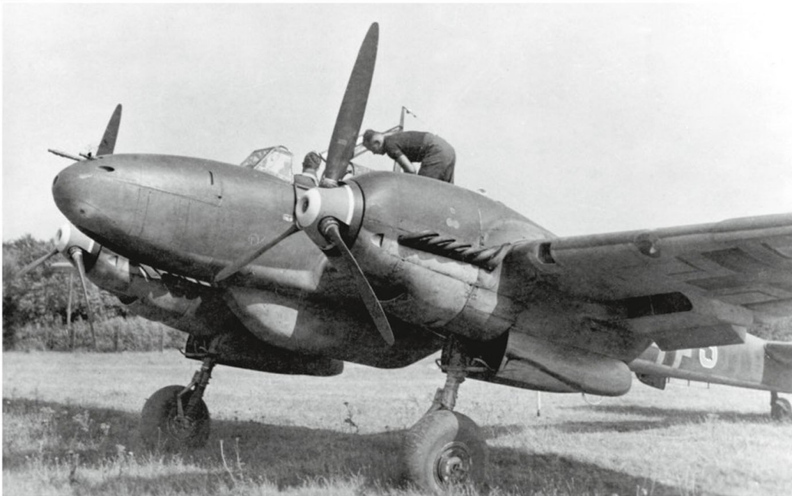
◀ Douze Bf 110 C-6, armés d'un canon MK 101 de 30 mm à la place des MG FF, sont produits en mai et juin 1940. Ils se révèlent de peu d'utilité comme Zerstörer et sont rapidement confiés à l'Erp. Gr. 210, première unité de chasse-bombardement de la Luftwaffe, pour les attaques de cibles terrestres. (Collection C. Goss)
