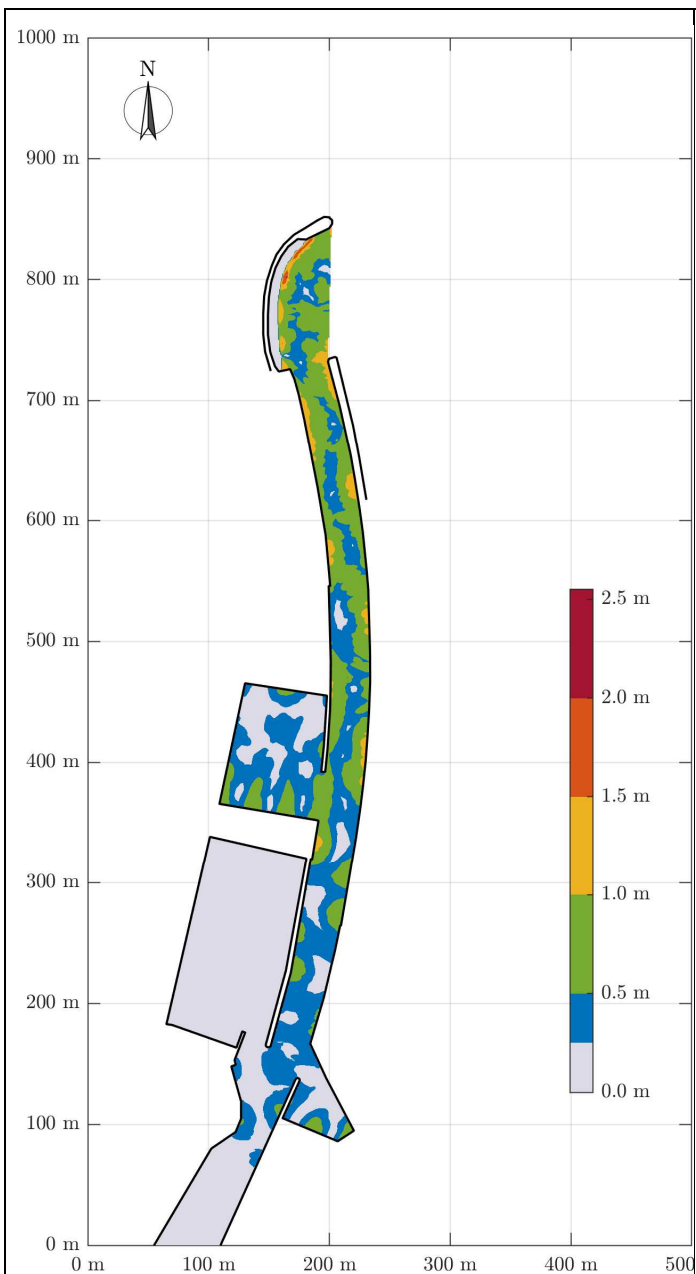
Rys. 8.3 Obliczone wysokości fal w porcie w Łe- bie po przebudowie w ramach Koncepcji 1. Kierunek podchodzenia fali: NNE Parametry fali H_s=3.71 m, T_p=10.29 s
