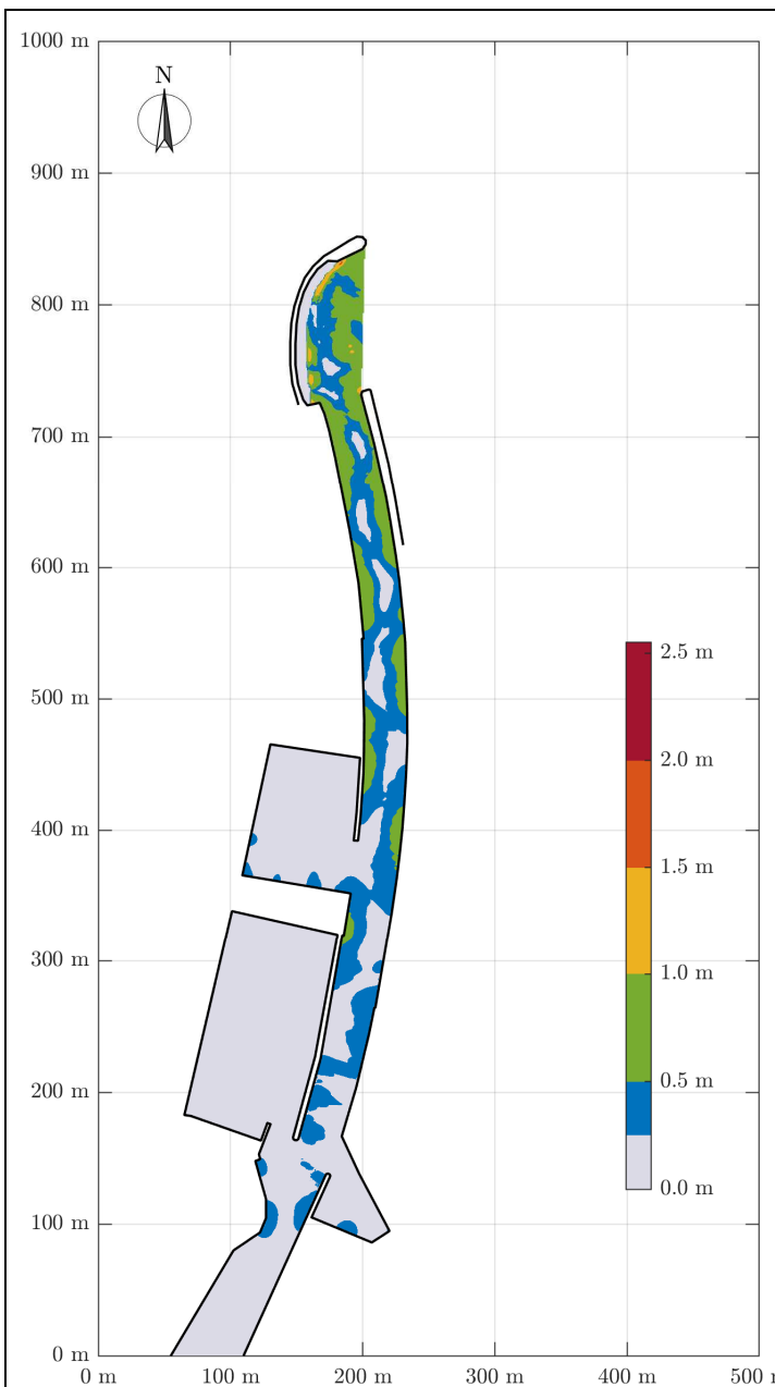
Rys. 8.1 Obliczone wysokości fal w porcie w Łebie po przebudowie w ramach Koncepcji 1. Kierunek podchodzenia fali: N Parametry fali H_s=3.82 m, T_p=10.65 s
