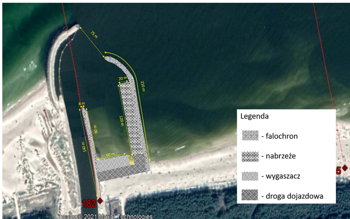
Rys. 7.2 Przebudowa portu w Łebie. Koncepcja 2. Budowa nowych nabrzeży i nowego falochronu wschodniego
