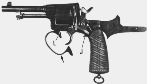
Bild 12: Gehäusedeckel aufgeklappt, hierzu muß der Abzugsbügel durch kräftigen Druck (Pfeil) entrastet und nach unten geschwenkt werden.
