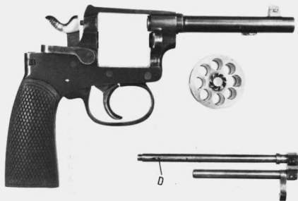
Bild 11: Trommelachse mit Entlader und Trommel ausgebaut, D = Bremsfeder zur Vermeidung eines Schlotterns der Trommel.
