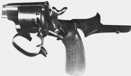
Bild 3: Die Gehäusedeckplatte ist auf einer Gelenkschraube gelagert und nach hinten ausschwenkbar.
