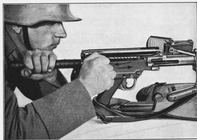
Bild 15: Durchladen (Kammergriff zurückziehen und loslassen)
