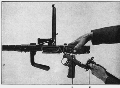
Bild 23: Nach Drücken des Riegels herunterklappen des Bodenstücks 1, = Hebel der Bodenstücksperre, 2 = Riegel zum Bodenstück
