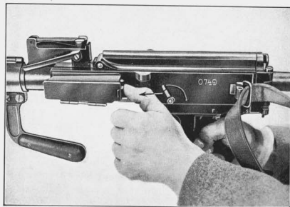
Bild 13: Öffnen des Magazinalthebels
