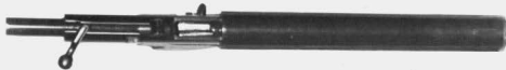
Bild 5: Deutlich ist auf der linken Seite die Abzug-Nase und rechts der Kammerstengel bei geöffnetem Schloß zu sehen. Blick von oben
