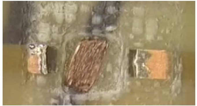
Fotografia 2. Przykład naprawy płyty wielowarstwowej – tymczasowe usunięcie ścieżki w wyżej położonej warstwie w celu uzyskania dostępu do warstwy głębszej ( https://bit.ly/46EiSe2 )
