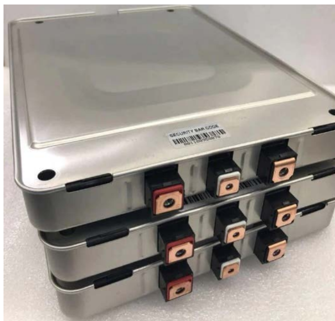
Fotografia 4. Akumulatory LMO stosowane w autach Nissan Leaf
