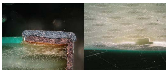
Fotografia 16. Widoki przekrojów PCB, obrazujące przykładowe uszkodzenia: po lewej – uniesienie pierścienia padu metalizowanego (PTH) i oderwanie go od powierzchni laminatu; po prawej – wnęka wewnątrz materiału, spowodowana delaminacją ( https://t.ly/s_jQa )
