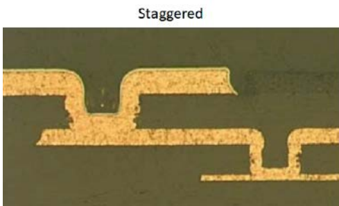
Fotografia 2. Przekroje mikroprowadów przesuniętych (staggered) i piętrowych (stacked) – https://t.ly/5ztQ2
