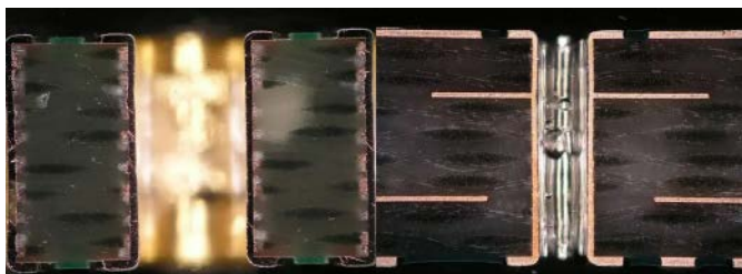
Rysunek 2. Przekroje przelotek w płycie dwuwarstwowej (po lewej) i wielowarstwowej (po prawej). Pęcherzyki w przelotce są zawieszony w żywicy
