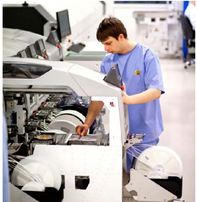
Fotografia 2. Uzbrajanie automatów Pick and Place
