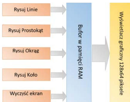
Rysunek 7. Koncepcja działania interfejsu graficznego obsługującego wyświetlacz LCD
