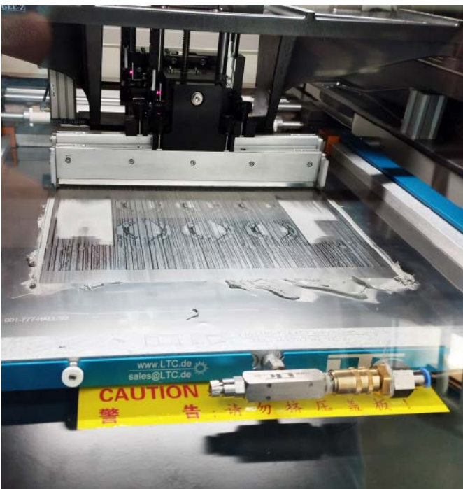
Fotografia 1. Nakładanie pasty lutowniczej w procesie montażu SMT
