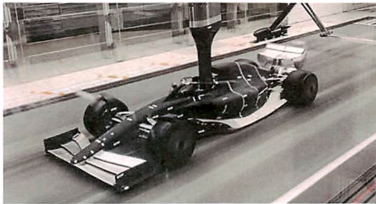
Eine Sonde misst im Sauber-Windkanal die Turbulenzen hinter dem Auto
