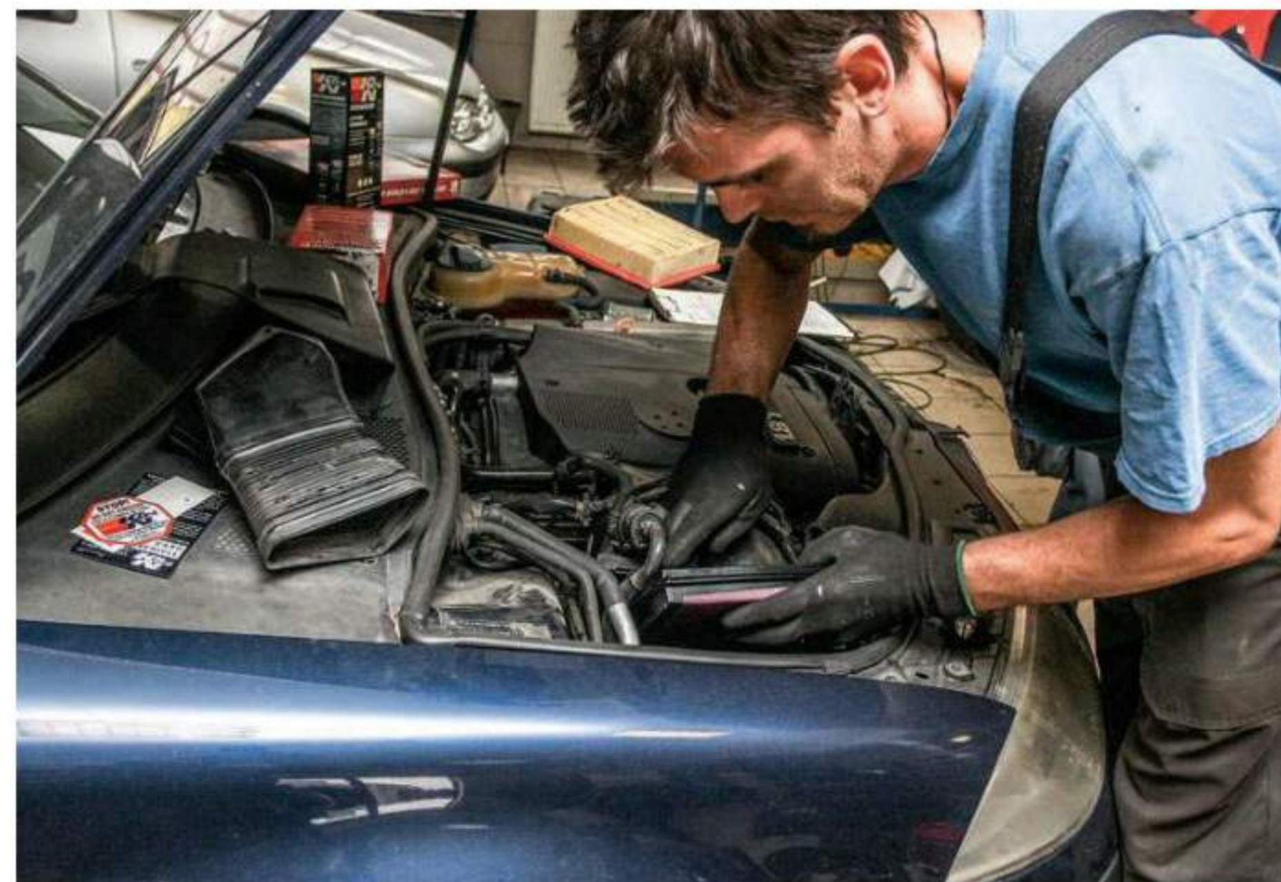
A sportbetétszűrő behelyezése könnyebb, mint a papírszűrőé, ez ugyanis vékonyabb felépítésű
