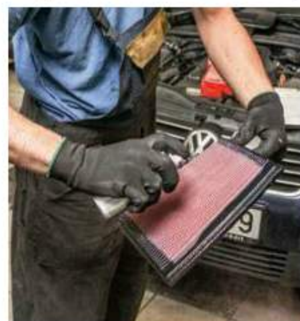
A szűrőolajat spray-ből lehet a filterre fűjni, gyárilag nem olajozott
