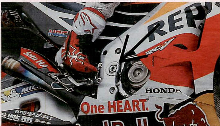
Schweißnaht an der Honda von Marc Márquez, durch die der Schwingendrehpunkt abgesenkt wurde
