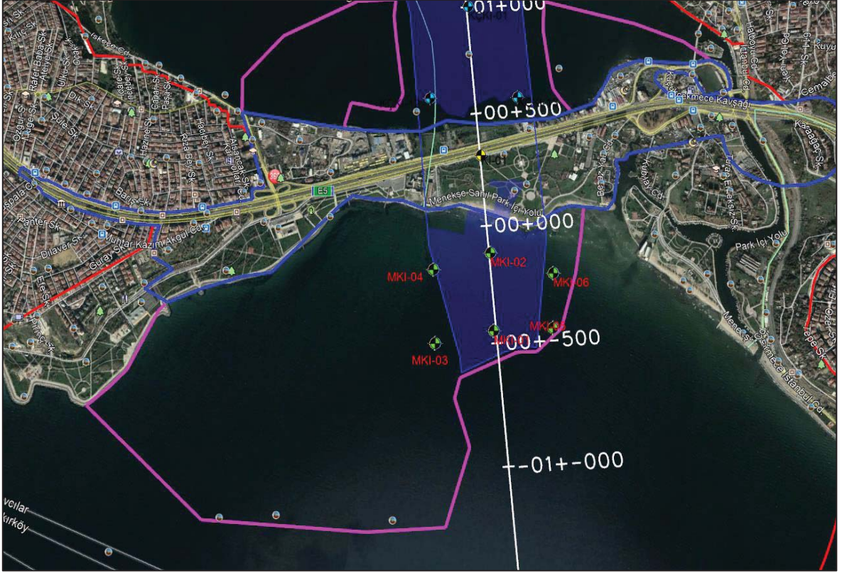
Şekil 5.6.1. Marmara Denizi İçinde Jeolojik-Jeoteknik Çalışmalar Kapsamında Yapılan Sondajlar
