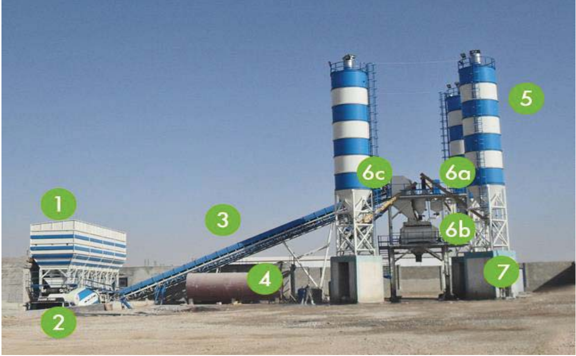
Şekil 3.2.6.5.1. Beton Santrali Makine ve Ekipmanları Kaynak: https://pimakina.com.tr/beton-santrali
