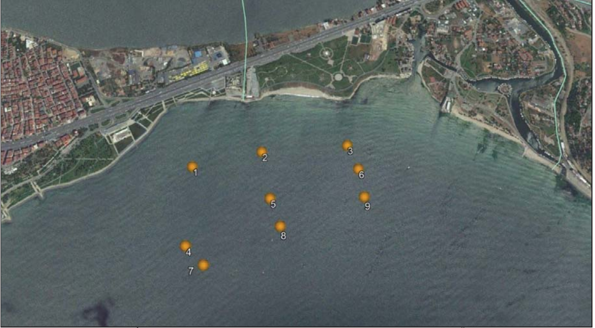
Şekil 5.8.2.9. Kanal İstanbul Marmara Denizi Girişi 2. ve 3. Aşama Bulanıklık (Turbidity) Ölçüm Noktaları
