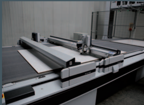
Een dubbele brug op de D3 zorgt voor capaciteit.
