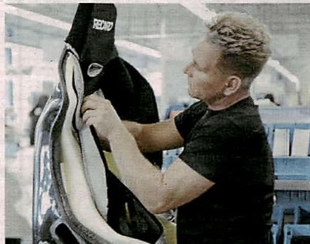
In Handarbeit: Der Rohling wird mit Polster und Bezug versehen
