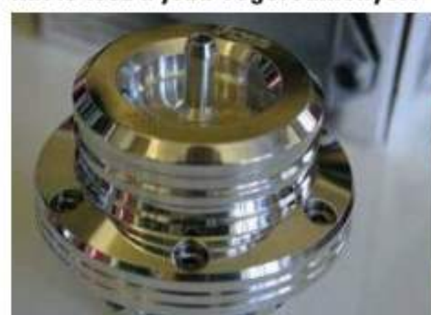
A lefűvószelep nem engedi el teljesen a töltőnyomást a rendszerből
