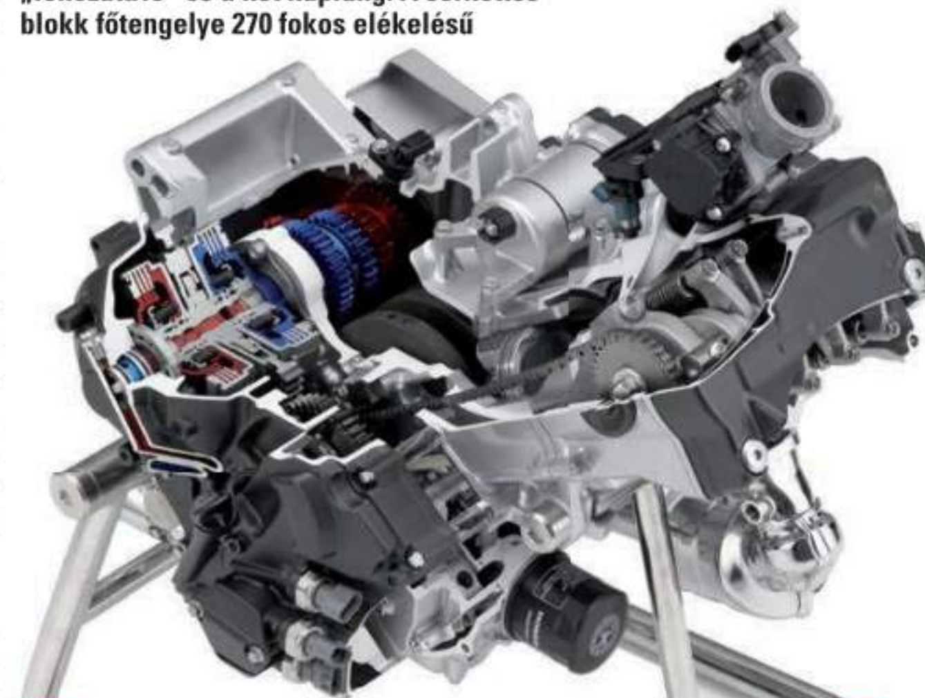
Közös tengelyen foglal helyet a két „fokozatú” és a két kuplung. A sorkettes blokk főtengelye 270 fokok elékelésű
