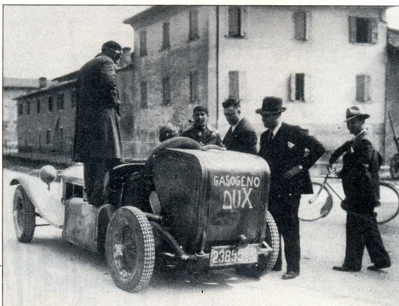
Durante l'ultima guerra e negli anni precedenti, si diffusero in Italia le auto a gasogeno che trasformavano in gas combustibile sostanze come il carbone. In alto, 1943; una Bianchi S9 berlina su cui spicca posteriormente l'impianto a gasogeno. A lato, Modena 1934: fra gli osservatori dell'Alfa 6C-1750 a gasogeno «Dux» del prof. Ferraguti, anche Enzo Ferrari (senza cappello). (Fotografie Zagari)
