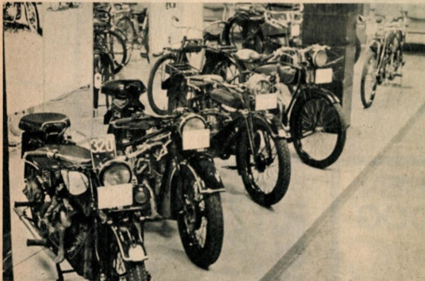
Ezül áll a Windhoff, soros, négyhengeres, 22 lóerős, olajhűtéses motorjával. A mellette álló BMW-t 1929-ben gyártották
