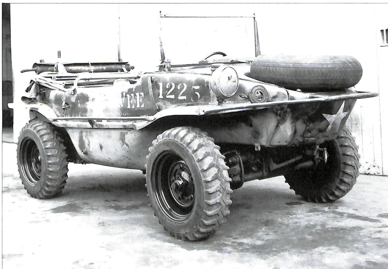
◀ Pourvu d'une nouvelle immatriculation, ce *Schwimmwagen* a été capturé par les Alliés. Ces derniers possèdent également dans leur arsenal un véhicule amphibie léger, la Ford GPA. Cela ne les empêche pas de réutiliser, à chaque fois qu'ils le peuvent, le modèle allemand ! Notez le pneumatique sur la partie avant, dont le profil est différent des quatre autres. Archives Caractère
