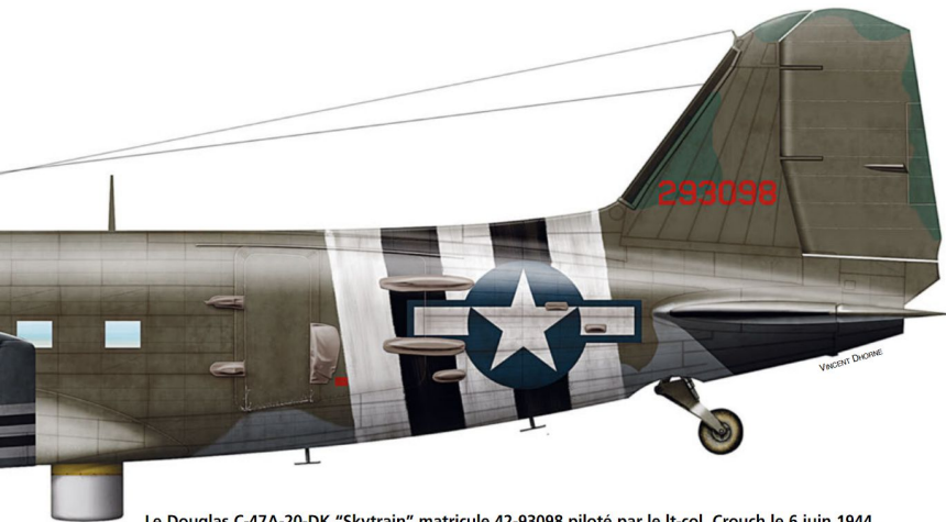
Le Douglas C-47A-20-DK "Skytrain" matricule 42-93098 piloté par le Lt-col. Crouch le 6 juin 1944, avec une des deux antennes du système Rebecca sous la vitre latérale du poste de pilotage et l'antenne du système de navigation "Gee" sous le ventre.
