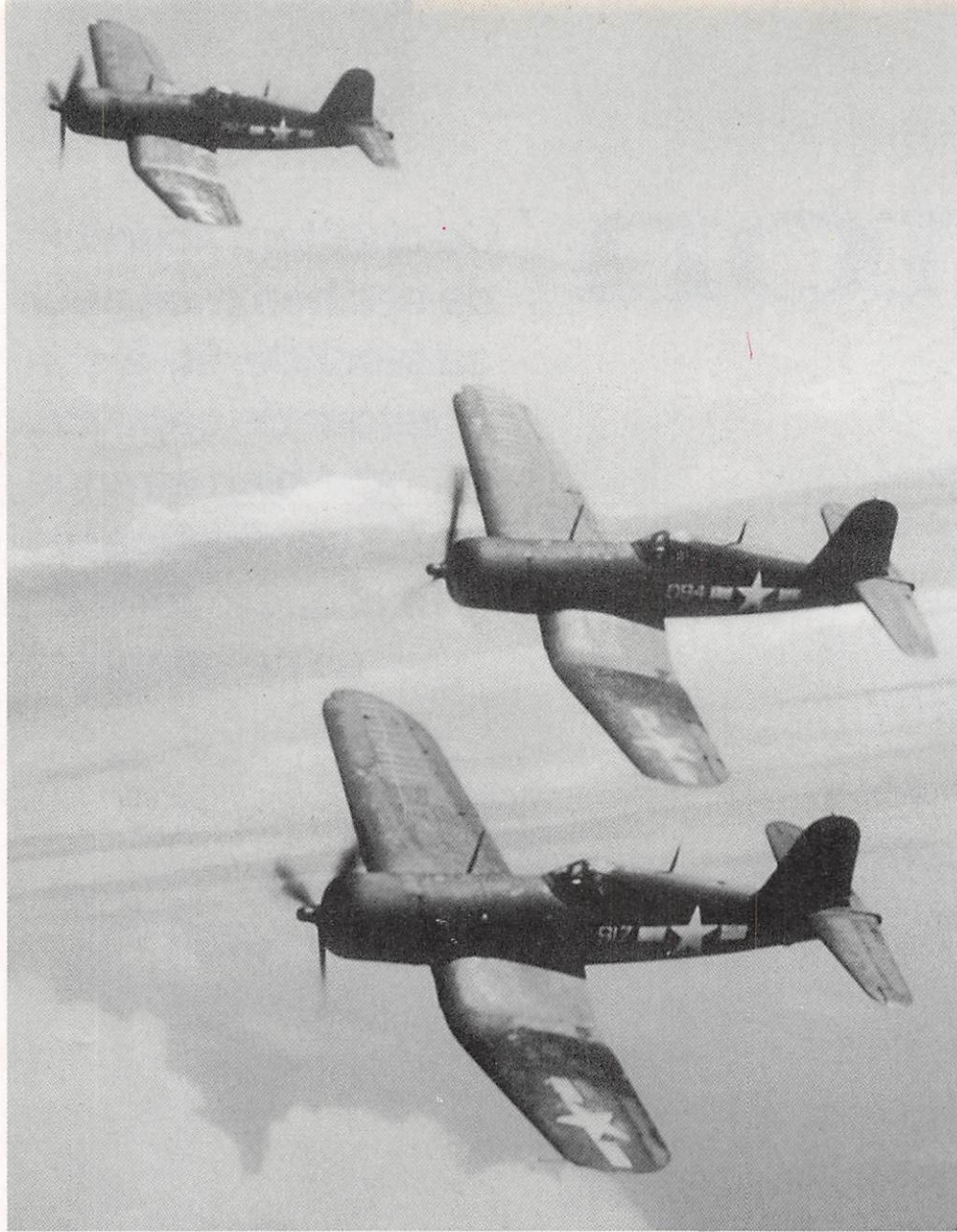
Des F4U-1A "Corsair" (noter la nouvelle verrière) de la VMF-214. Document National Archives.
