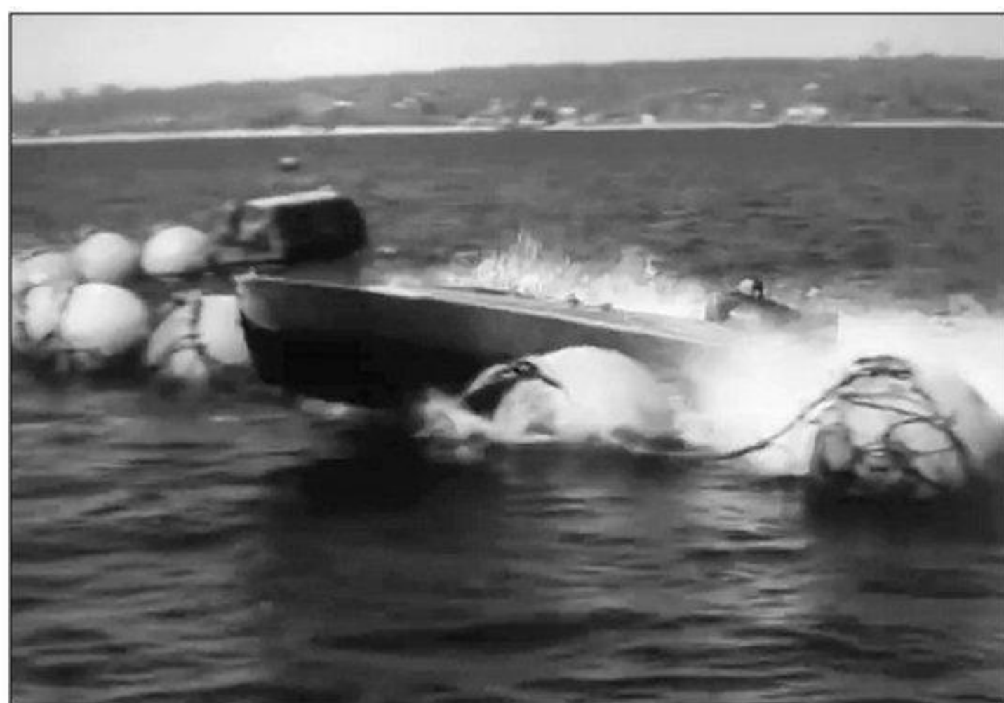
Grâce à une hélice escamotable, le MTM est capable de franchir des barrages de filets. (Capture d'écran German and Italian Sneak Craft )
