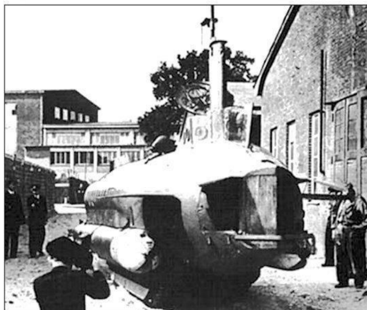
Conçu pour se déplacer dans l'eau ou sur la terre, le Seeteufel effectue des essais prometteurs. (DR)
