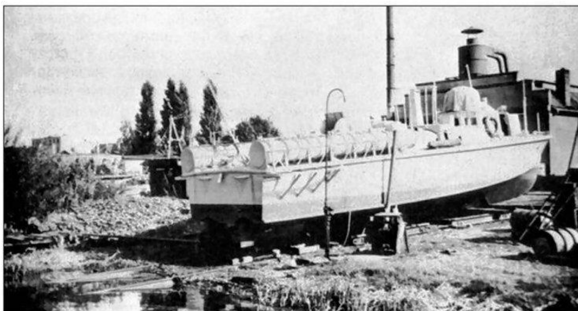
Les KS sont équipés, au cours de l'été 1944, de deux tubes lance-torpilles à l'arrière. (Document Fock Schnellboote)
