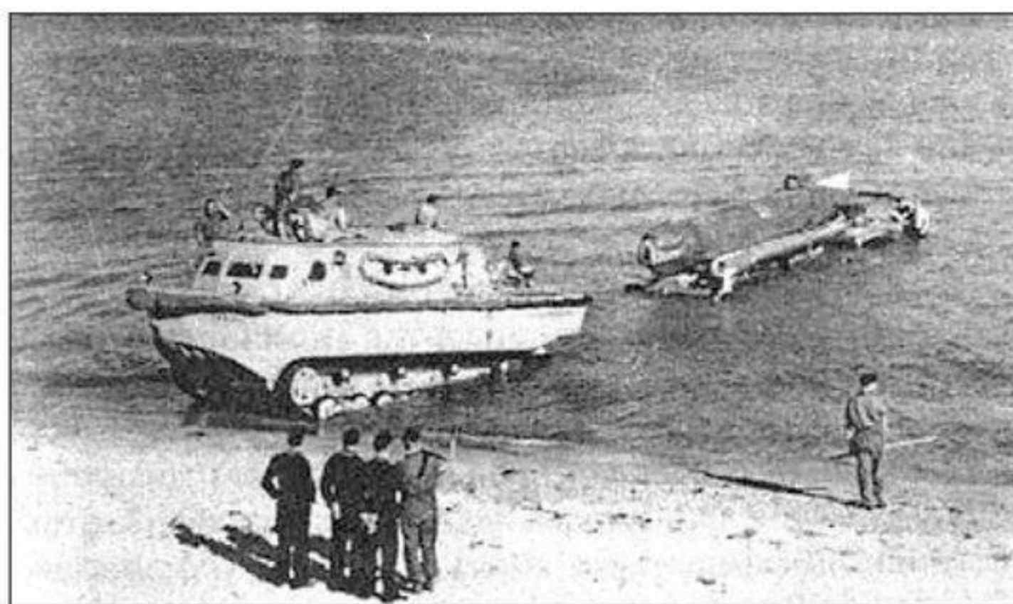
Un autre moyen de mettre un Molch à l'eau avec l'aide d'un L.W.S. ( Land Wasser Schlepper ). (DR)
