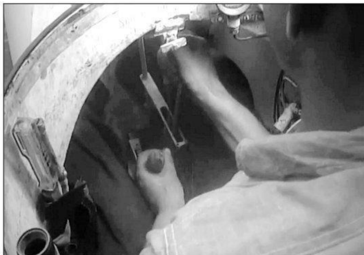
La main droite sur la barre du Marder , la gauche s'apprête à actionner le levier de largage de la torpille. (Capture d'écran German and Italian Sneak Craft )
