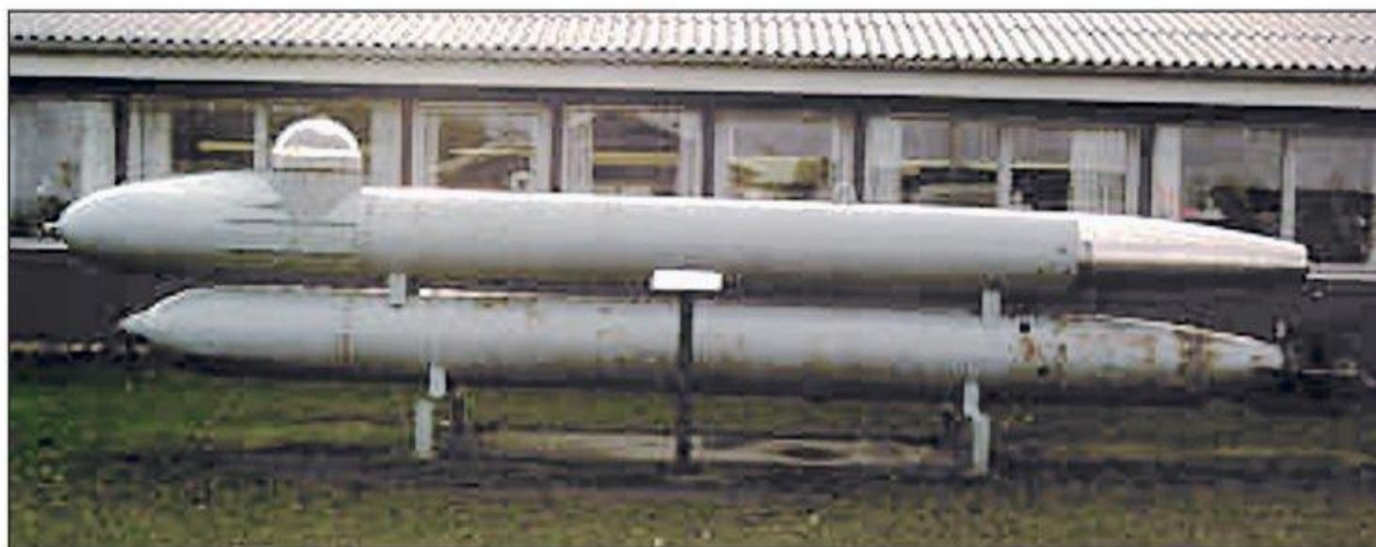
Rallongé pour accueillir un réservoir de plongée, le Marder peut atteindre une profondeur de 10 m. (DR)
