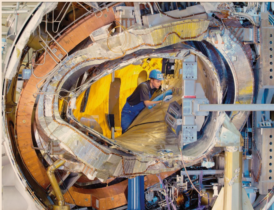
Made in Italy. Un magnete Asg per il reattore a fusione Stellarator Wendelstein W7-X
