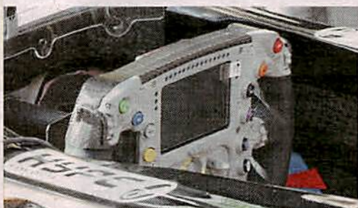
Kunststoff statt Karbon: Neues Force-India-Lenkrad
