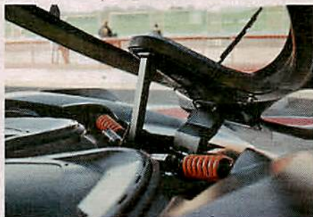
Pushrod-Aufhängung und «Kampfjet»-Dach
