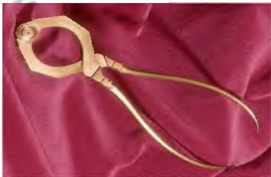
Gheară compas pentru măsurarea distanței pe globuri, cca. 1600
