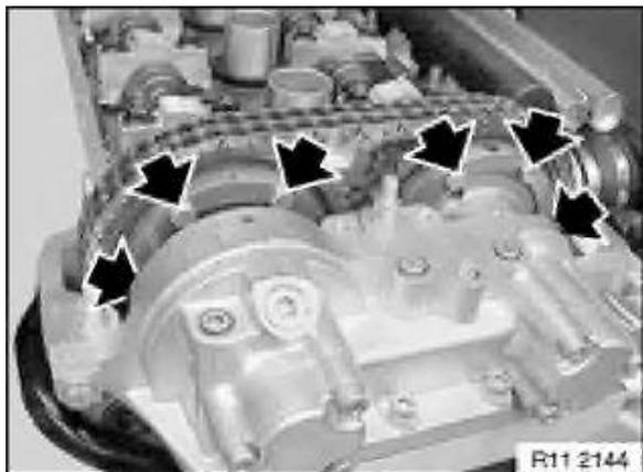
Die zugänglichen sechs Schrauben (drei auf der Auslass- und drei auf der Einlassseite) am VANOS-Getriebe mit **14 Nm** festziehen.
