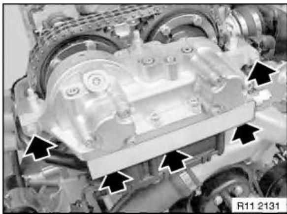
Die restlichen Schrauben einsetzen und festziehen.
