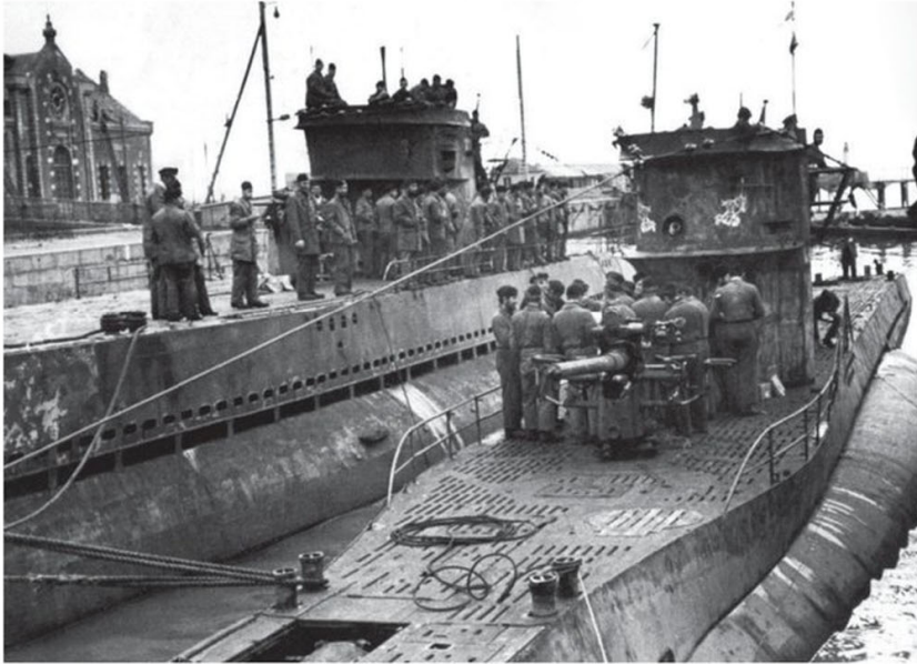
▲ Un U-Tanker Typ XIV aux côtés d'un Typ VII à quai. La différence de hauteur de pont est ici bien mise en évidence. DR
