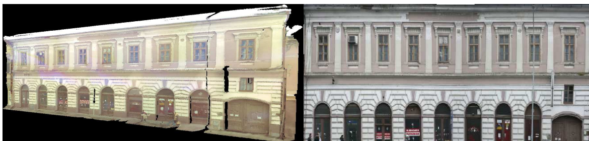
Слика 8. Ласерско скенирање фасаде објекта у Вршцу, орто-фото план дела фасаде
