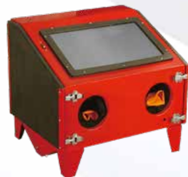
BWR5133 029540 ΚΑΜΠΙΝΑ ΑΜΜΟΒΟΛΗΣ 150LT • Ωφέλιμος εσωτερικός χώρος εργασίας Μ63xΠ45xΥ48cm • Συνοδεύεται με πιστόλι και μπεκ αμμοβολής
