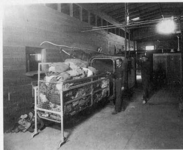
Secadora de vapor para esterilizar la ropa en el puente Santa Fe, 1917. (U. S. Public Health Service, National Archives)
