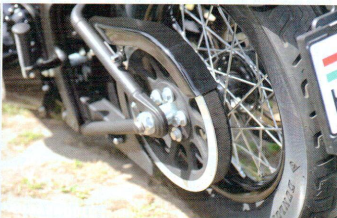
A hagyományokhoz híven szíj továbbítja az erőt a hátsó kerékre
