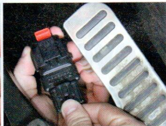
Az elektronika csatlakoztatása a gyári stekkerhez
