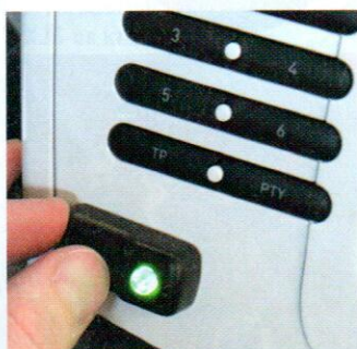
Kapcsoló a középkonzolon. A zöld fény az elektronika középpontos állású helyzetét jelenti
