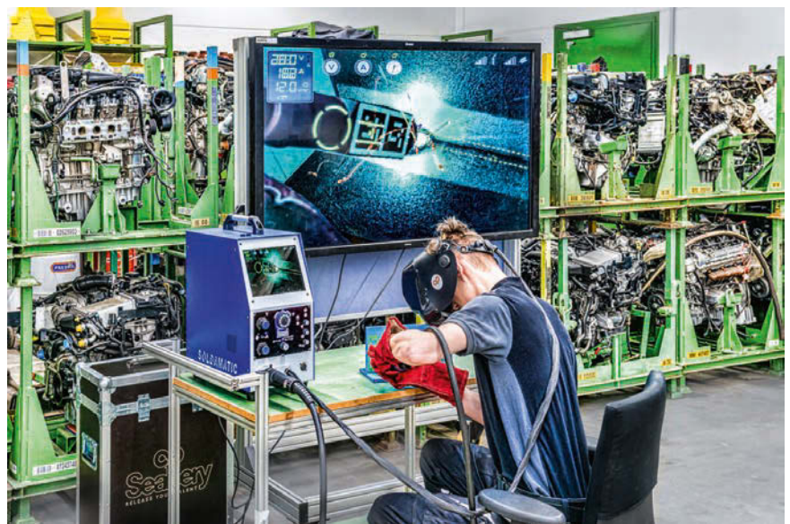
▲ Bild 1. Beim neuen Trainingskonzept des „Augmented-Reality(AR)-Schweißens“ wird nur das Werkstück animiert.
