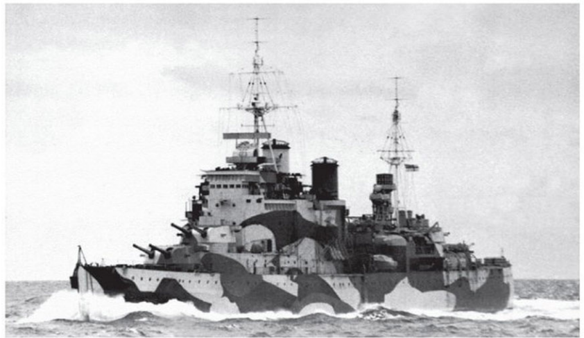
▲ Le London en 1942. Une longue refonte a totalement modifié l'allure du bâtiment. Les superstructures massives sont directement inspirées des croiseurs légers de la classe Colony . L'antenne rectangulaire du radar télémétrique Type 284 disposée sur la tourelle de télémétrie avant est bien visible, tout comme le radome du radar de veille Type 273 devant le mât arrière.
