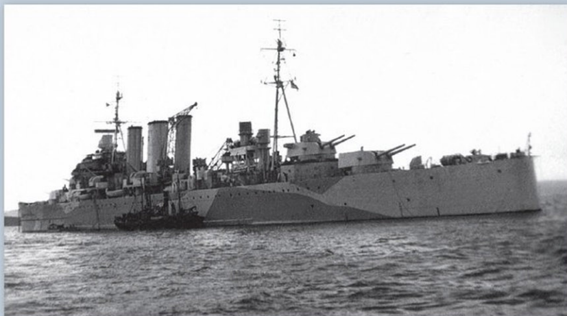
▲ Le Berwick à Scapa Flow alors qu'il est affecté à la protection des convois de l'Arctique. Lors d'un ultime carénage à Rosyth fin 1943, toutes ses installations aéronautiques sont débarquées et le hangar rasé, permettant l'érection d'un mât pour le radar de veille surface Type 273, visible ici.
