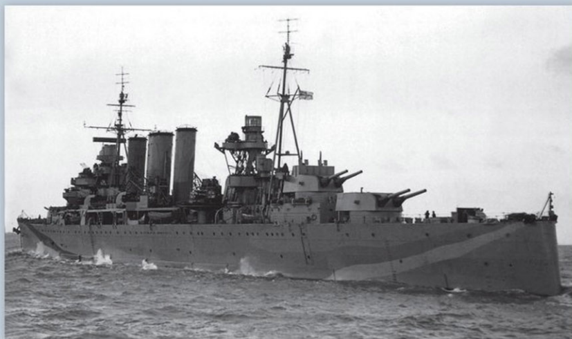
▼ Le Kent en 1943. Basé à Scapa Flow, il assure alors l'escorte des convois vers l'URSS. L'affût octuple de 40 mm bâbord est visible derrière la troisième cheminée.
