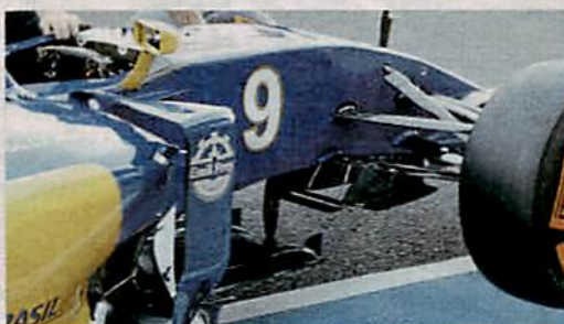
Sauber: Neuer Splitter und vollendeter Unterboden
