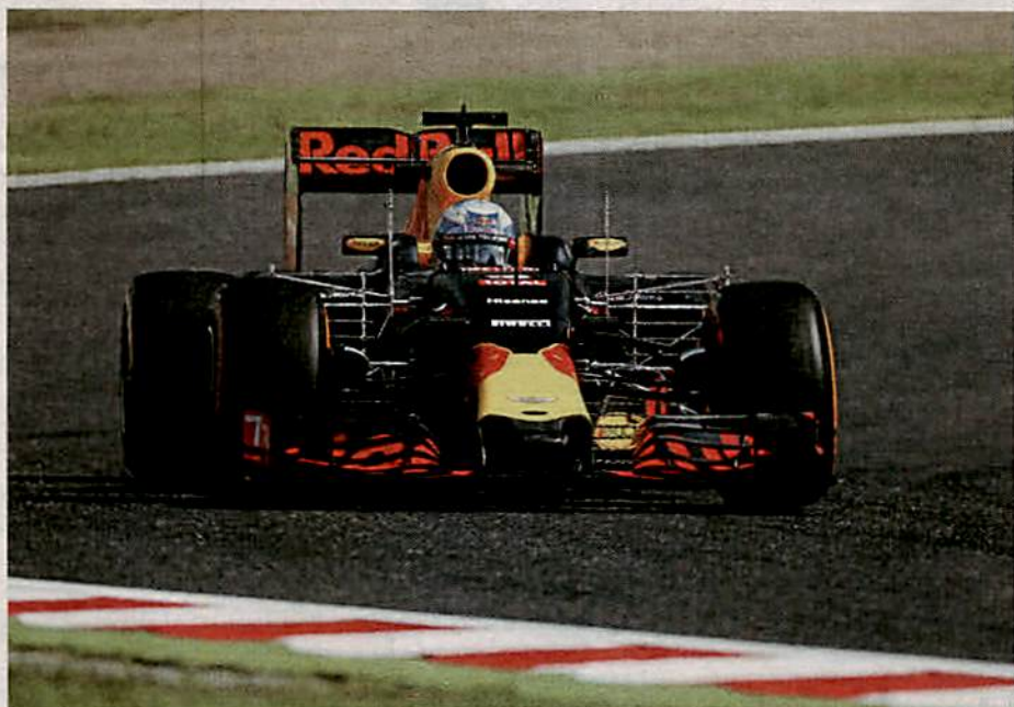
Red Bull kontert Ferrari-Offensive: Daniel Ricciardo mit riesigen Messgittern an seinem RB12
