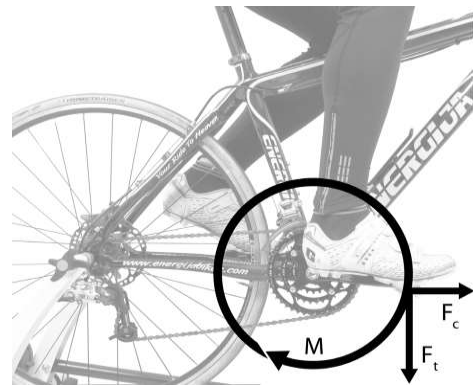
Fig. 1: Forze applicate al pedale. FT: forza tangenziale, FC: forza centrifuga, M: coppia propulsiva.
