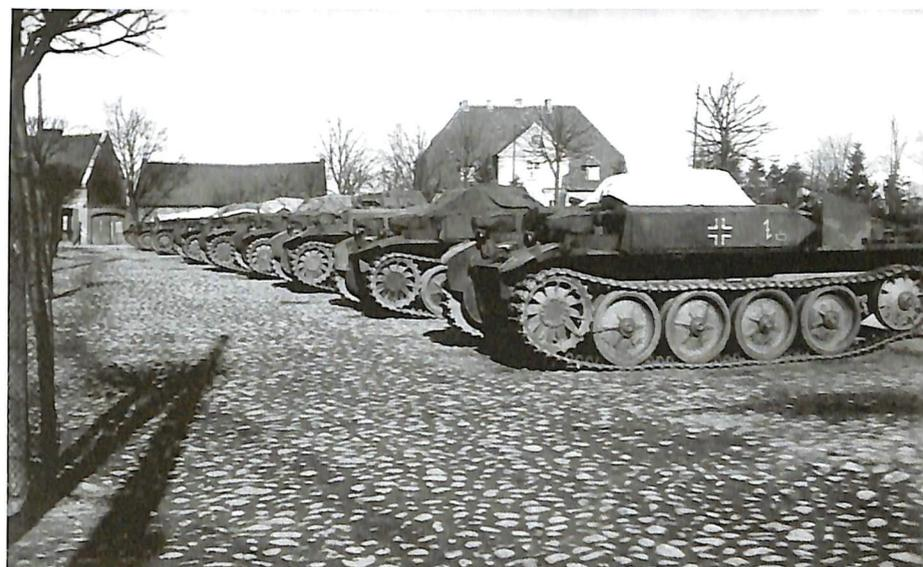
▲ Bel alignement de *Panzer II (Flamm)* portant le code tactique de la 19. *Panzer-Division*. Les tourelles sont recouvertes d'une bâche, et les petites tourelles (appelées *Spitzköpfe*) abritent les projecteurs des lance-flammes sont enveloppées dans un capuchon.
