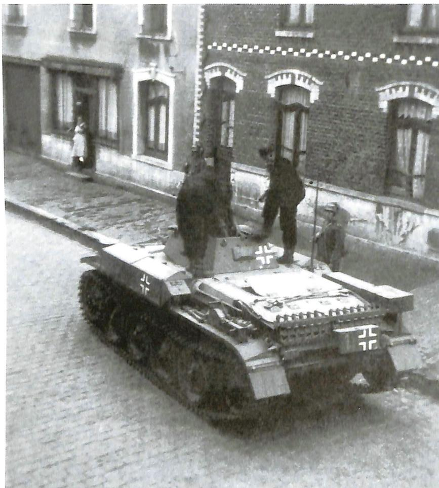
▲ L'équipage d'un Panzer II (*Flamm*), ici debout sur son engin, se compose de trois hommes : un chef de char qui officie aussi comme servant pour un des deux lance-flammes et la mitrailleuse de tourelle, un radio également chargé de mettre en œuvre le deuxième lance-flammes et un pilote. La multitude de tâches ne facilite pas la réactivité au combat.
