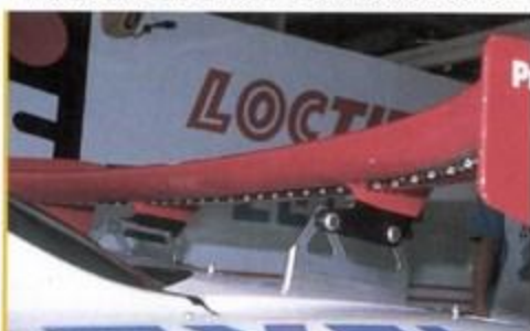
風洞実験を繰り返した結果、装着されたボータックスジェネレーター。モノは小さいがその効果には大きなものがあるという
