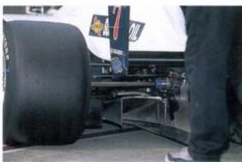
ディフューザーの裏に見えるのが下出しエキゾーストの排気口だ
