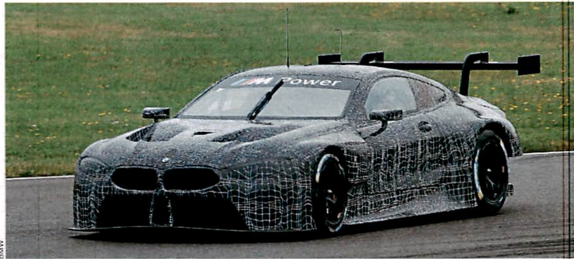
Der M8 für die GTE-Klasse ist ein großes Rennauto geworden, schließlich baut er auf dem Siebener-Chassis auf
