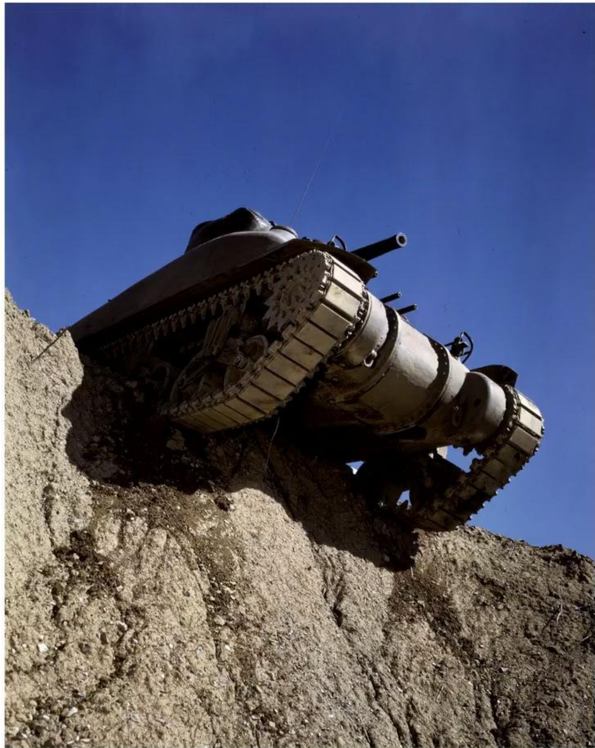
▲ Medium Tank M4A1 de tout début de série (les deux mitrailleuses fixes de caisse sont encore présentes). Cette version est la première variante du Sherman à être assemblée (dès février 1942 avec 6 281 exemplaires, contre juillet 1942 pour le M4 avec 6 748 engins). LOC
