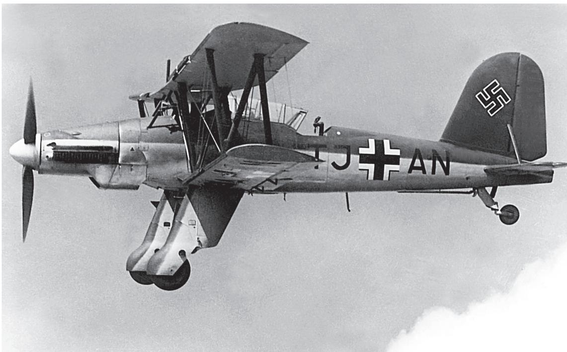
▲ Autre vue de l'un des trois prototypes du bombardier polyvalent Arado Ar 195. Sur les Ar 195 comme sur les Ar 197, les carénages de train d'atterrissage et de roulette de queue jouent le rôle de déflecteurs de brins d'arrêt, afin d'éviter que le filin tendu sur la largeur du pont ne s'enroule dans les roues au moment de l'appontage. (E-N Archives)
