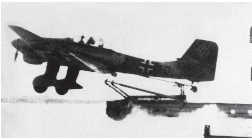
▲ Mai 1940. Le prototype Junkers Ju 87 V10 (TK+HD) est catapulté depuis le ponton flottant aménagé à l'*E-Stelle See* de Travemünde. Une crosse d'appontage, plutôt fragile d'apparence et d'un modèle qui ne sera pas retenu sur le Cäsar, est visible sous le fuselage arrière. (EN-Archives)
